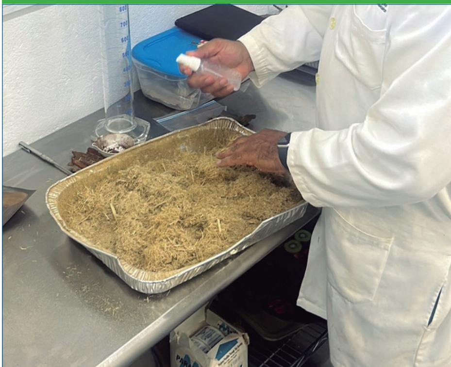
La adición de agua tiene el propósito de acondicionar el aserrín, ya que un aserrín muy seco no se compactará en la etapa de peletizado. Es deseable que la humedad de los residuos sea de 8 a 12 % respecto al peso del aserrín. Hay que evitar que el aserrín se encuentre totalmente mojado; debe quedar solamente humedecido. Se recomienda adicionar el agua haciendo uso de un atomizador y mezclando el aserrín humedecido de manera manual, y medir el porcentaje de humedad (Figura 13).
