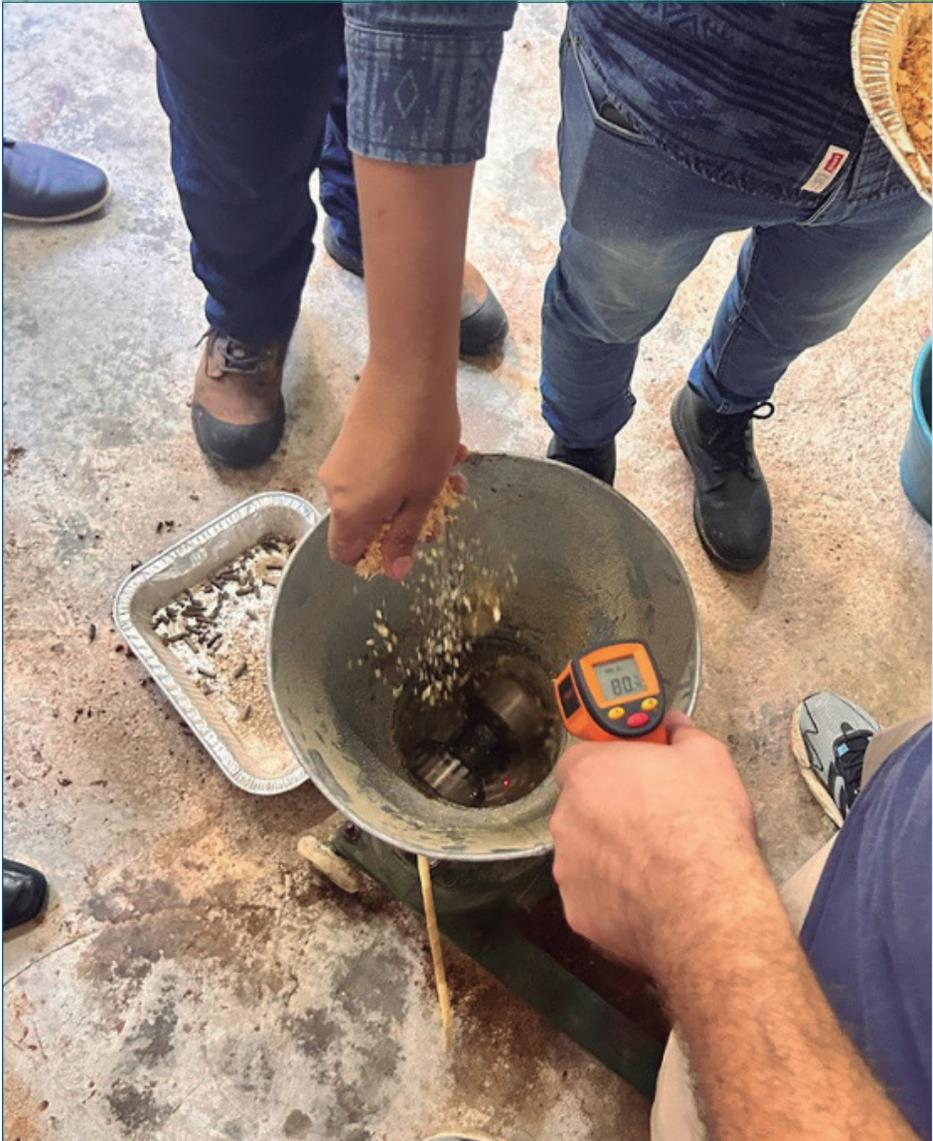
La alimentación del material a la tolva de la peletizadora debe realizarse de manera continua hasta que pueda visualizarse la salida de los pélets. En caso de que los rodillos no se muevan, se deben ajustar los tornillos que ajustan la separación entre los rodillos y la matriz (Figura 9), para hacerlos descender de manera simultánea.
