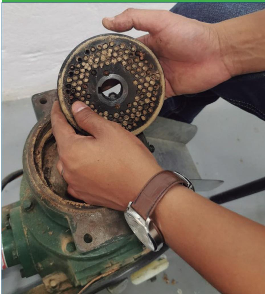
Finalmente, los pélets producidos pueden ser depurados y cribados separando aquellos que tengan un tamaño pequeño, los cuales pueden ser re-procesados añadiéndolos de nueva cuenta a la mezcla de material a peletizar (Figura 18). Al terminar operaciones se recomienda el uso de aceite vegetal para la lubricación de los metales y el buen procesamiento de materiales.
