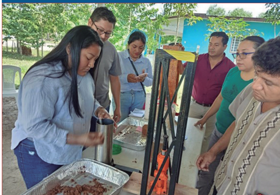
Figura 24. Elaboración de briquetas combustibles a partir de aserrín con prensa rústica en diplomado dirigido a técnicos del programa Sembrando Vida y Jóvenes Construyendo el Futuro
