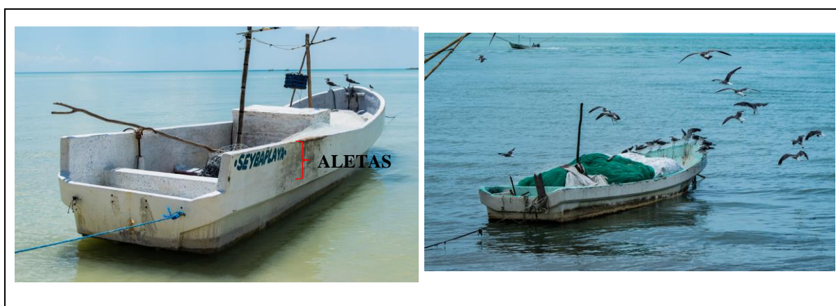
Figura 8. Modificación de las embarcaciones. La embarcación de la izquierda con aumento de altura. La embarcación de la derecha con la altura de fábrica, sin transformaciones.
