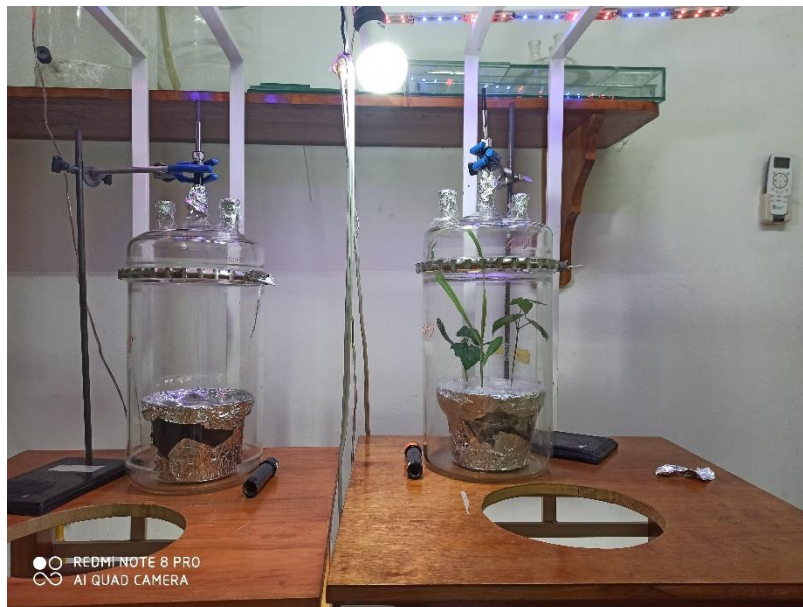
Figura 4. Colecta de compuestos volátiles de plantas en policultivo y un control utilizando la técnica de microextracción en fase sólida.
