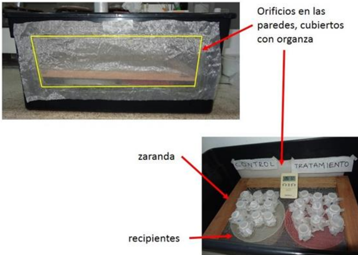
Fig. 2. Cámara húmeda albergando frascos aireados con broca y sustratos
