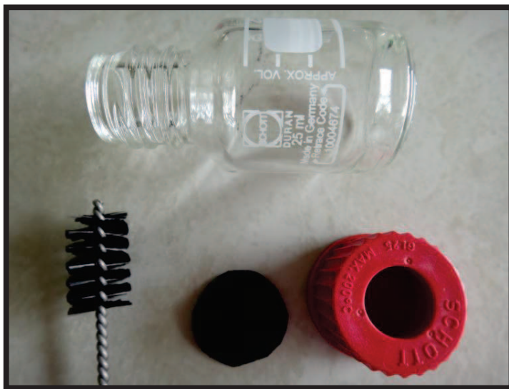
Figura 1. Materiales de fabricación de celdas microbianas.
