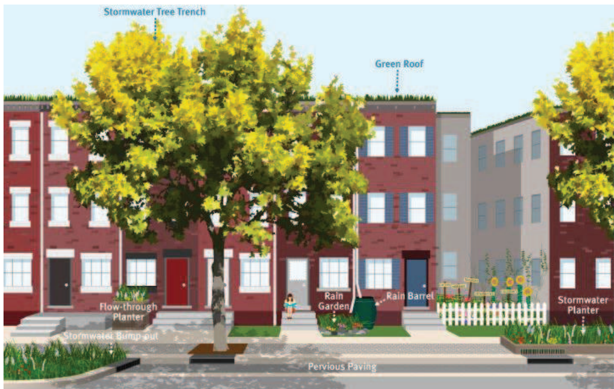
Fig. 4.2 Visión de las herramientas de infraestructura verde para el manejo de aguas pluviales en los barrios de Filadelfia (Philadelphia water department, s.f.).
