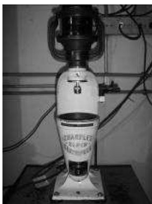
Fig. 5. Supercentrífuga, equipo utilizado posterior al fermentador
